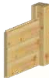
L'empilement entre poteaux rainurés
